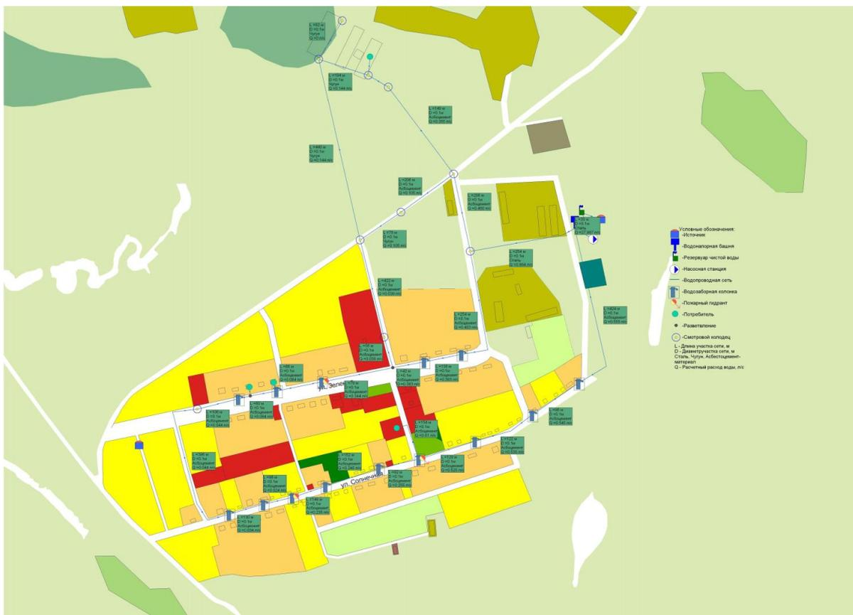
Рисунок 8 - Существующая схема водопроводной сети д. Богословка
