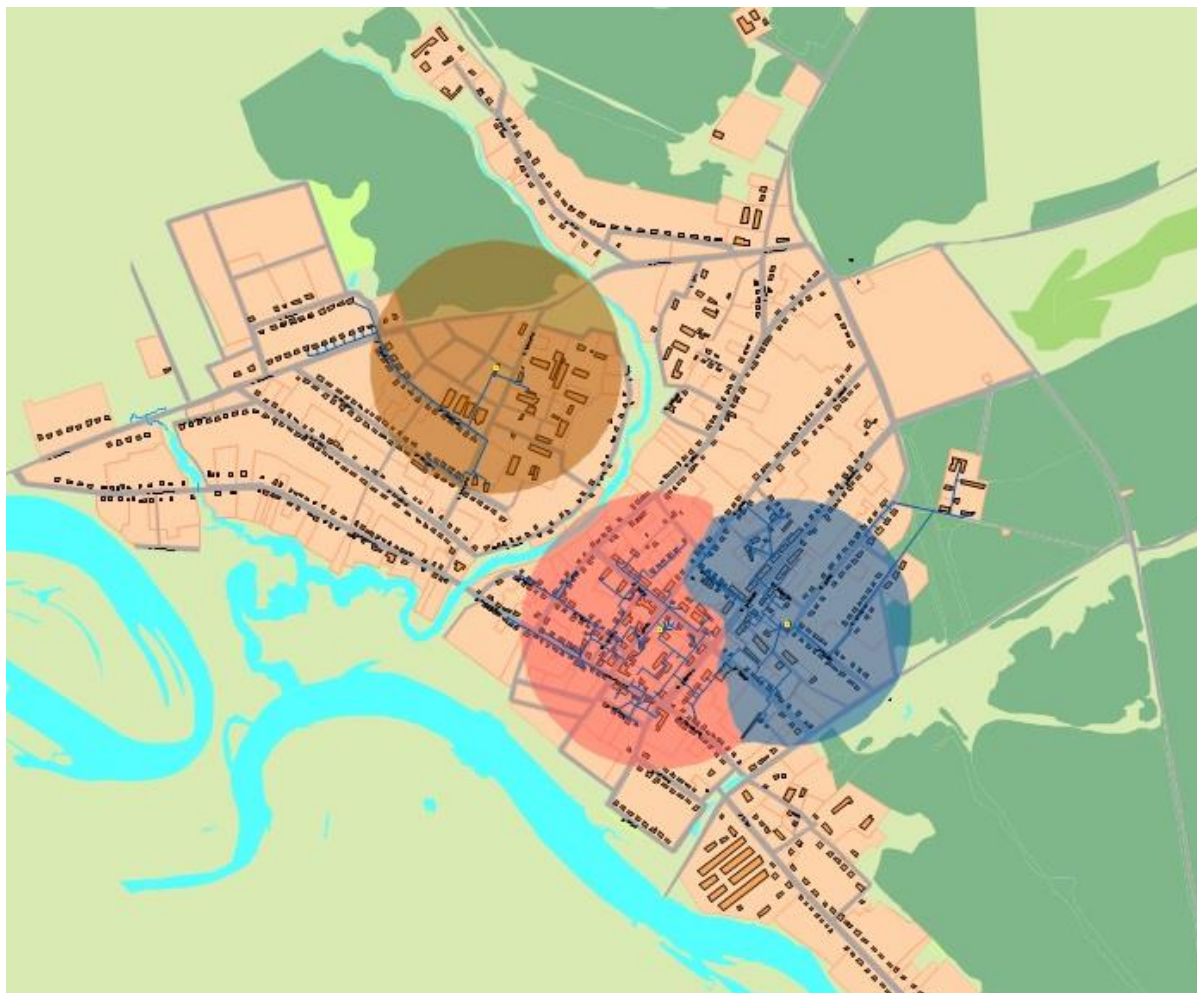
Рисунок 14. Радиус эффективного теплоснабжения от котельных
